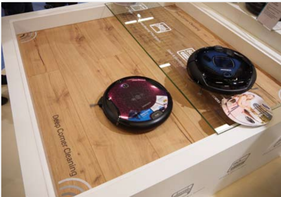
Встроенная камера и система определения местоположения робота-пылесоса Samsung NaviBot CornerClean VR10F71UB позволяют ему «ориентироваться» в комнате, не возвращаясь к уже убраным местам
